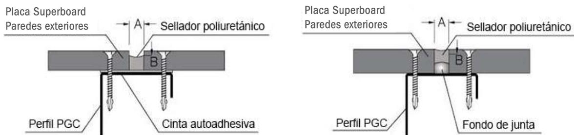
**Aplicación:** instale cinta de enmascarar a los bordes de las placas, con el objeto de delimitar la junta , instale el cordón de fondo y aplique el sellador poliuretánico, verificando que este llene la totalidad de la junta. Rehundir con espátula en el caso que sea necesario
